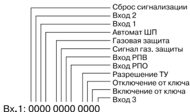
Расписание входных дискретных сигналов устройства в режиме «Контроль»
